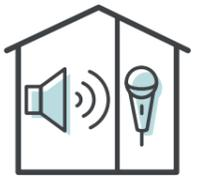
Schalldämmung ist wichtig, wenn sich Quelle und Empfänger in verschiedenen Räumen befinden.
